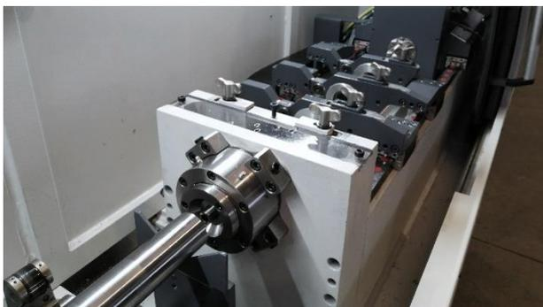
Die Tiefbohrmaschinen der IMSA-Serie MFT sind für zylindrische Werkstücke konzipiert, die entlang ihrer Rotationsachse gebohrt werden müssen.
