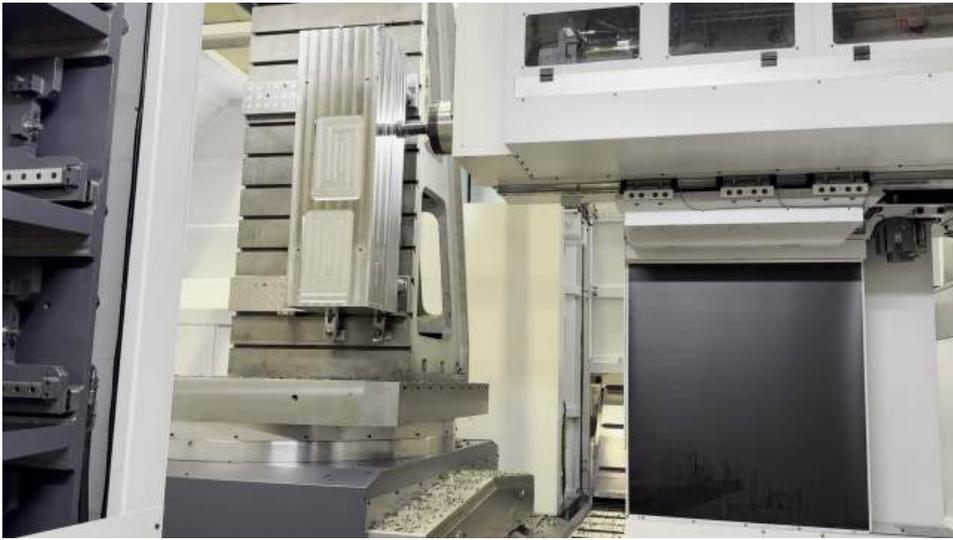
Die Steifigkeit der Struktur und schnelle Vorschübe von 20 m/min ermöglichen es, dieses Bohrzentrum auch für Hochleistungsfräsen zu nutzen.
