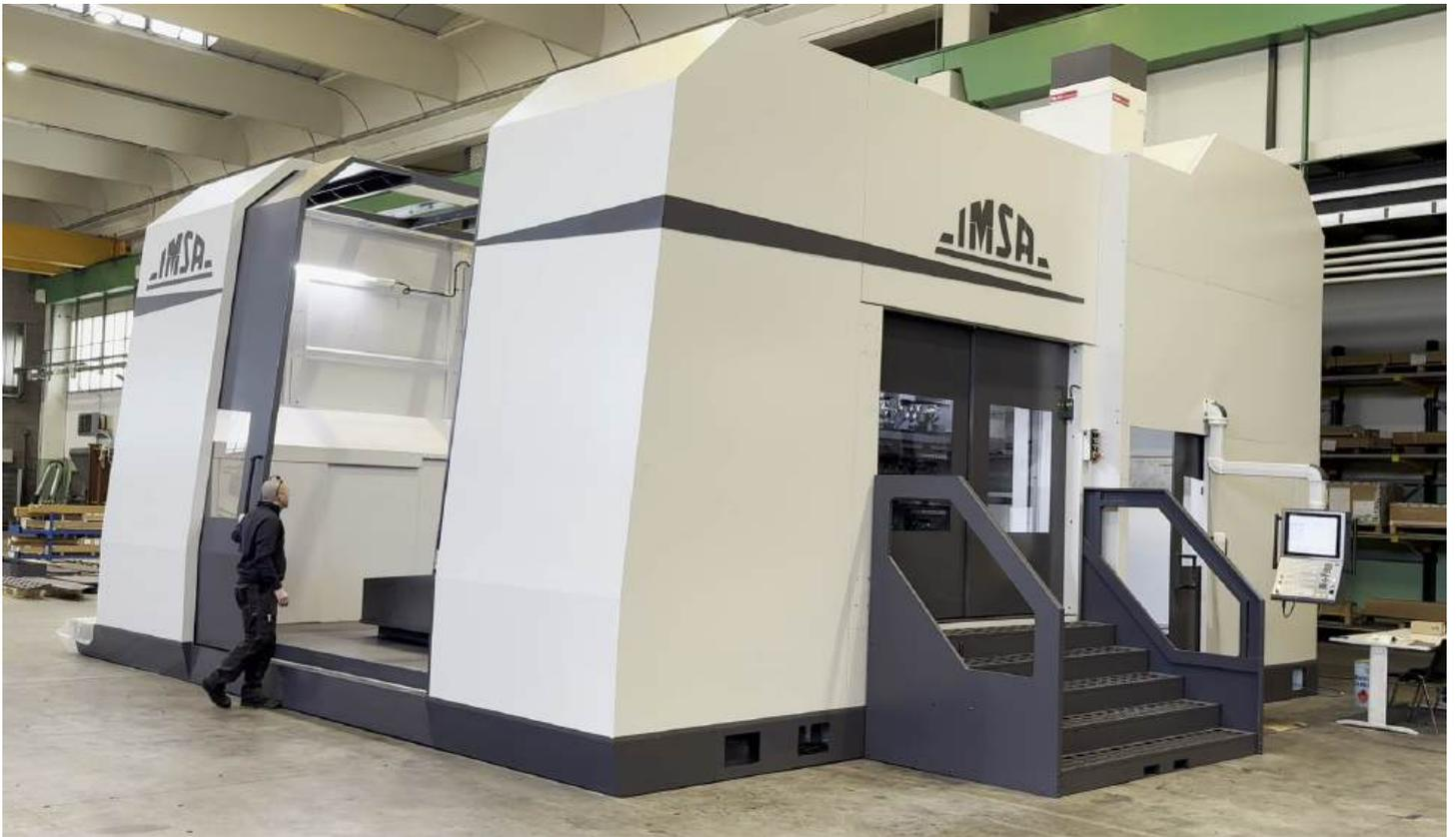
**MF1650/5P EVO von I.M.S.A. ist eine Tiefbohr- und Fräsmaschine für Blöcke bis zu 30/40/50 Tonnen, je nach gewähltem Tisch.**
