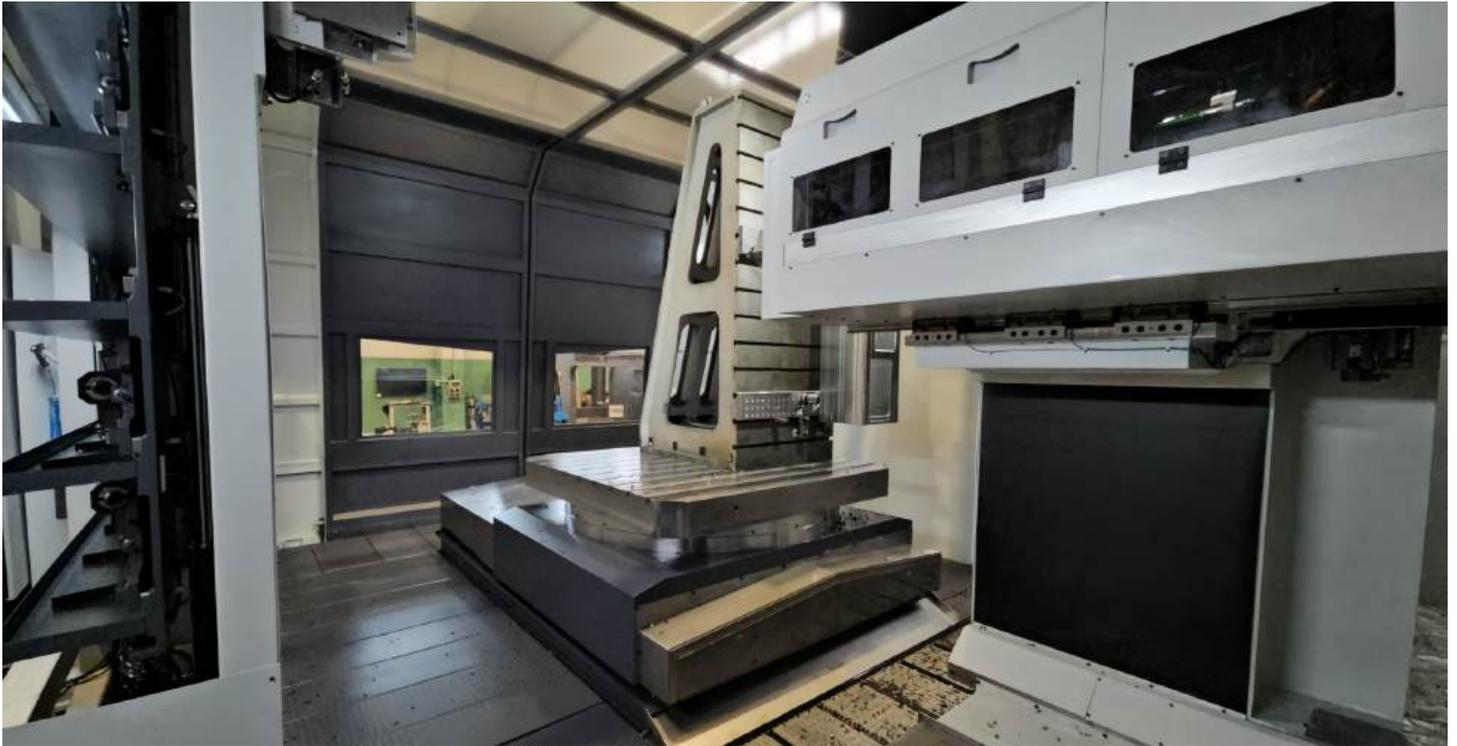
Die gesamte Fläche einer Form mit den Maßen 3.000x2.000 mm kann bearbeitet werden. Zusätzlich erleichtert die Tischachse die Drehung großer Formen.
