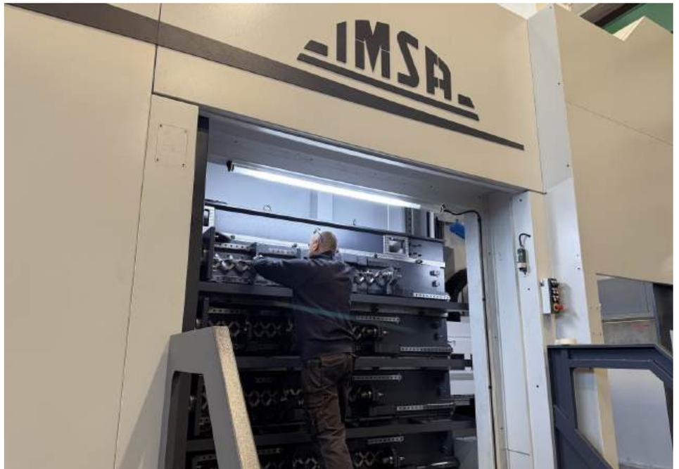
Das Tiefbohr-Wechselsystem ermöglicht es, den Bohrweg mit einem einzigen Durchmesser zu verlängern oder bis zu fünf verschiedenen Durchmessern einzuwechseln.
