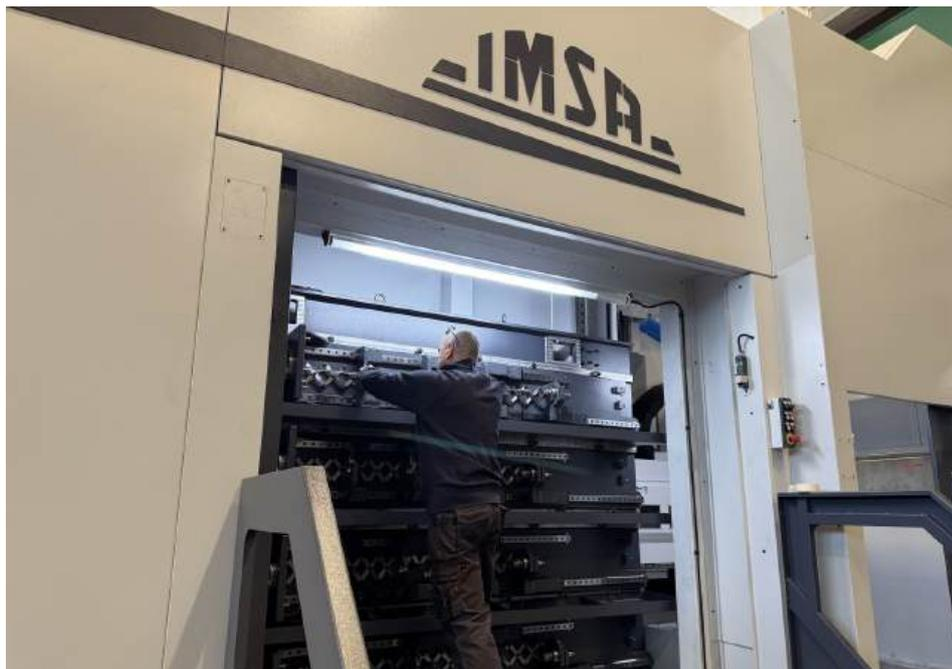
**Le système de changeur de forets permet de prolonger l'autonomie de perçage avec un seul diamètre ou de gérer directement jusqu'à cinq diamètres différents.**
