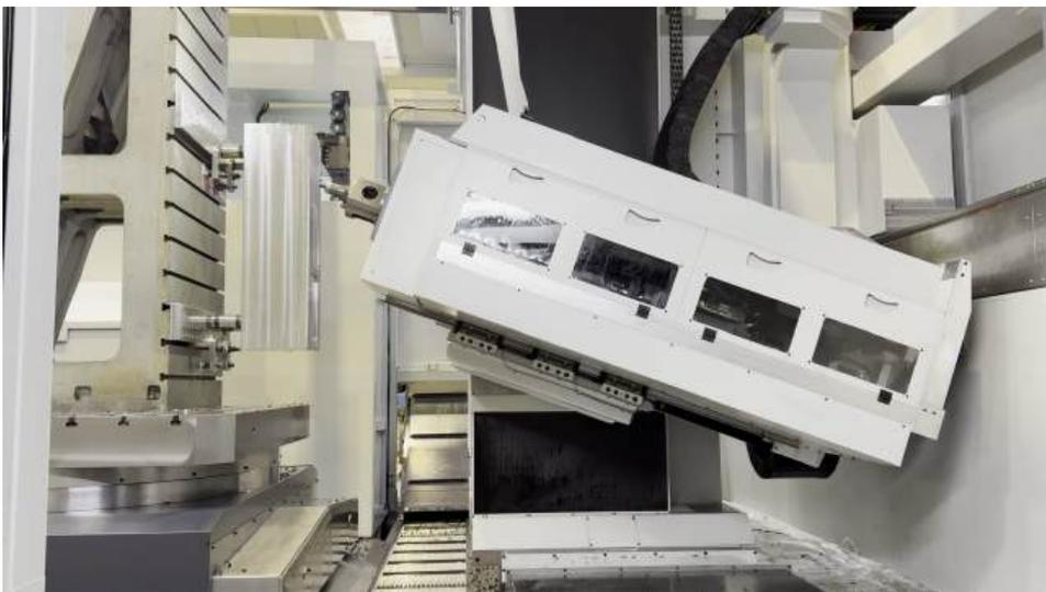
La rigidité élevée de la structure permet l'utilisation de forets à canon avec plaquettes brise-copeaux, pour percer jusqu'à 50 mm de diamètre dans le plein sans avant-trou.
