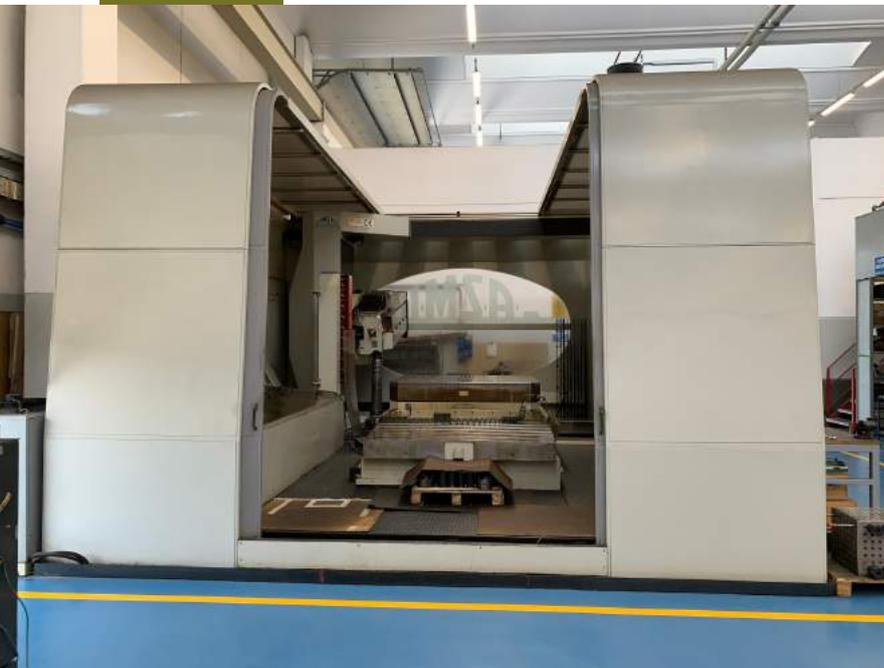
à partir du plein. Cette performance est garantie dans n'importe quelle position verticale, grâce à la structure à colonne à portique vertical qui supporte la colonne à la fois en bas et en haut (16 fois plus de rigidité qu'une colonne guidée uniquement en bas). L'usinage à double inclinaison est également possible, grâce à la combinaison de la table rotative et du RAM inclinable. Le RAM dispose de deux broches séparées pour le forage profond et le fraisage à commutation entièrement automatique.
