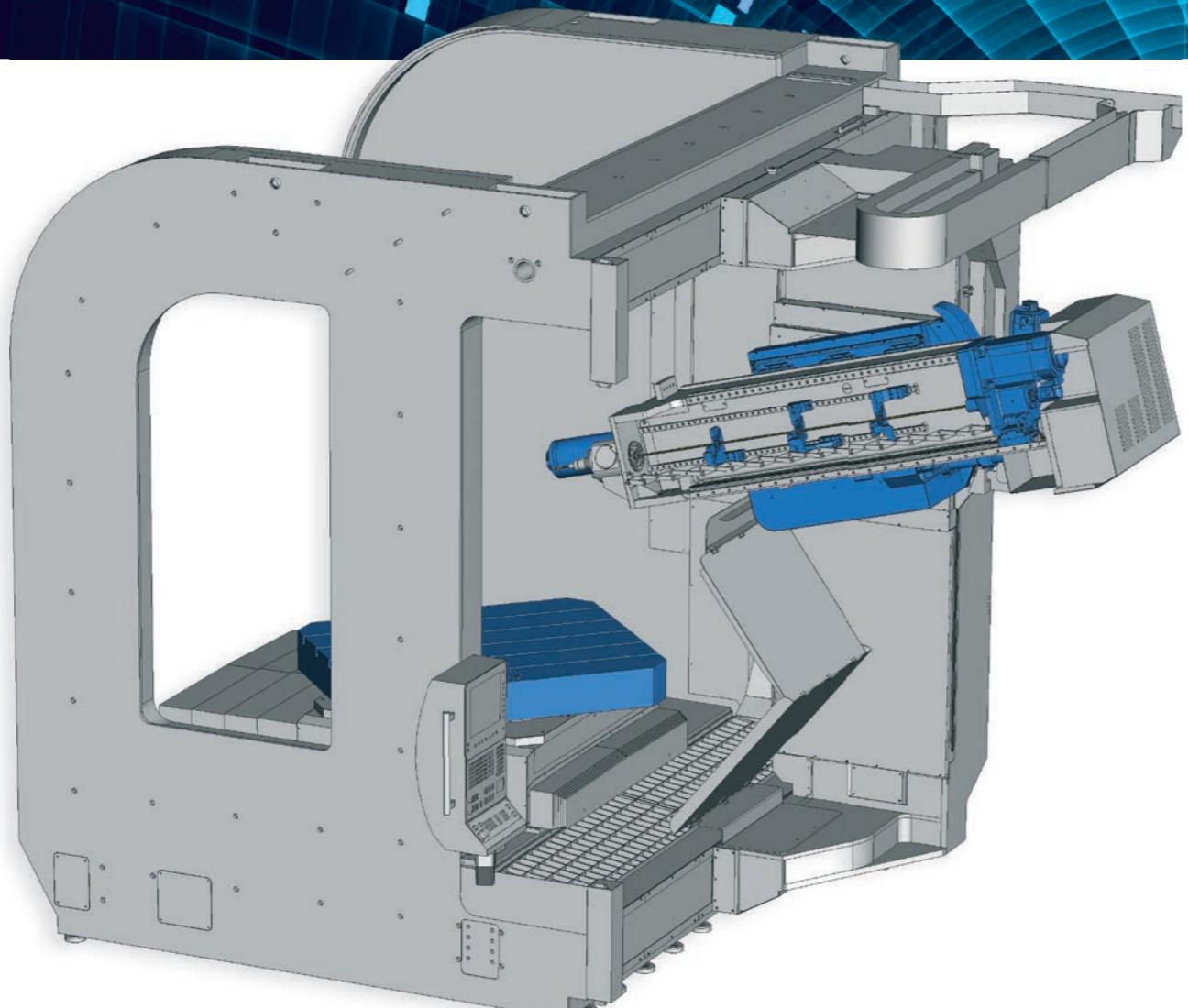
Um den nutzbaren Verfahrweg bei gekippter Bohr-Fräseinheit zu maximieren, wurde das Drehzentrum der A-Achse im Vergleich zur vorhergehenden BB-Serie verlagert. Dazu geschieht die Einstellung der A-Achse mit einem besseren hydromechanischen Bremsystem.
