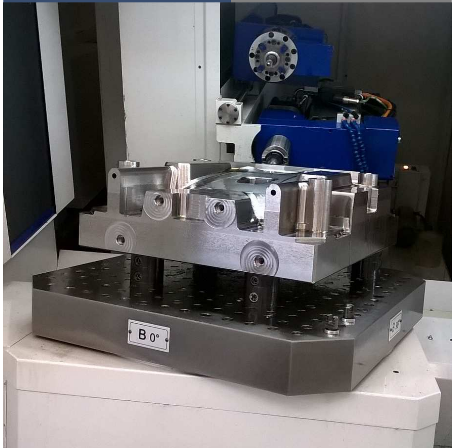
La machine de forage profond et de fraisage MF1000C a répondu aux besoins de nombreux fabricants de moules de 2 à 4 tonnes.
