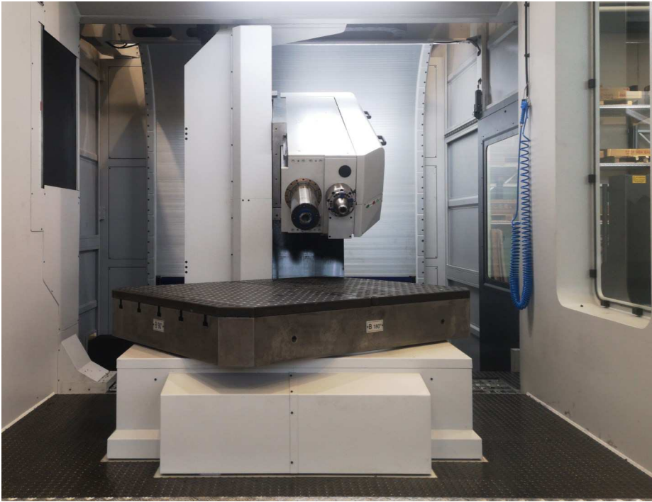
Le centre de forage profond et de fraisage MF1350EVO pour les moules et matrices jusqu'à 12 t.
