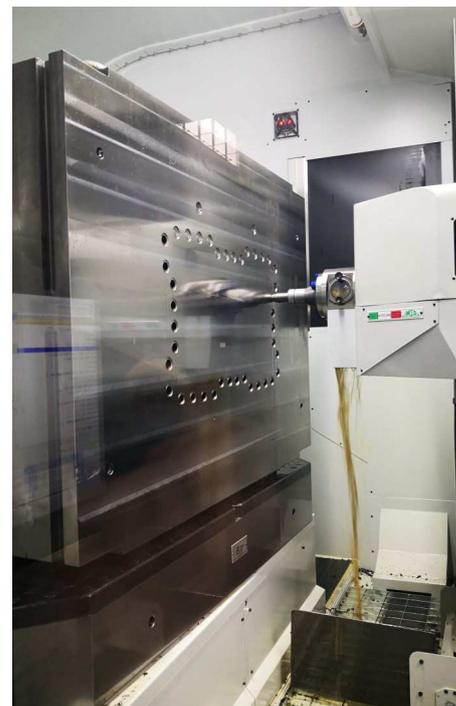
Die 500. I.M.S.A.-Bohrmaschine in Betrieb bei Exacta Stampi in Brianza (Mod. MF1350EVO).
