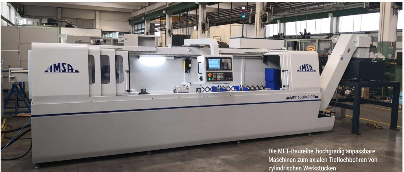
Die MFT-Baureihe, hochgradig anpassbare Maschinen zum axialen Tieflochbohren von zylindrischen Werkstücken
