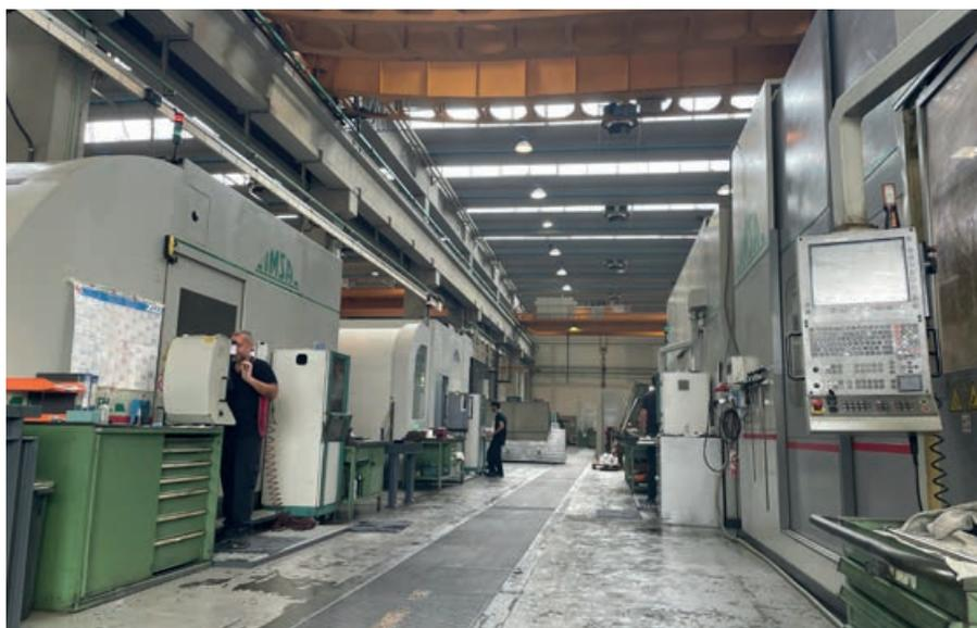
**Dans l'îlot de forage profond, les machines sont disposées de manière à ce que l'accès aux équipements se fasse toujours vers l'intérieur de la cellule afin de faciliter le flux de travail**
