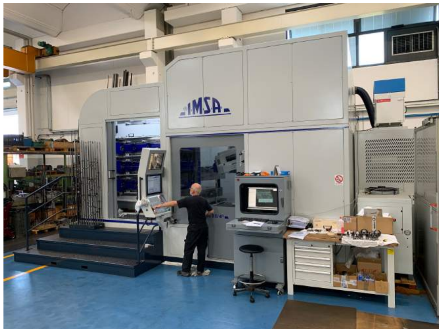
III Das Tiefbohrzentrum IMSA MF1300/4P EVO in der Werkzeugabteilung von R.S. Meccanica.
