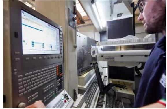
Gemeinsame Merkmale der beiden, von Claren Tools ausgewählten IMSA-Zentren sind der vertikale Portalständer, der für maximale Steifigkeit sorgt, und das unabhängige Spindelsystem zum Tiefbohren und Fräsen, das lange manuelle Bearbeitungsvorgänge ermöglicht.
