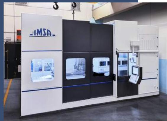
Blick auf das Spitzenmodell des Tiefbohr- und Fräszentrums MF 1750 EVO von IMSA, das mittlerweile seit Ende letzten Jahres bei Claren Tools voll in Betrieb ist.
