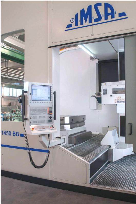
**Die numerische Steuerung Heidenhain TNC 640 hat spezifischen Funktionen und Arbeitszyklen zum Tiefbohren.**
