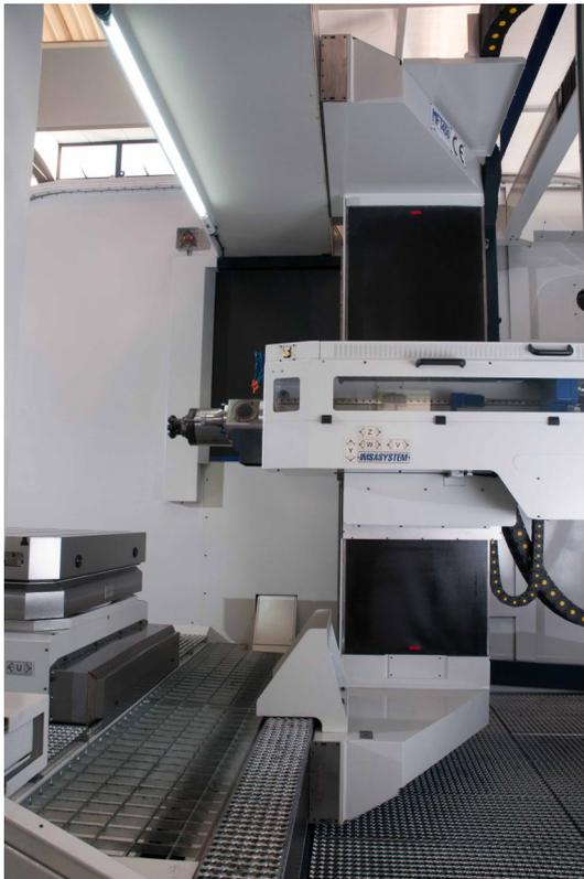
Für die Fräsbearbeitungen ist die Maschine mit einem automatischen Werkzeugmagazin ausgerüstet, das je nach Bedarf mit 20, 40, 60 oder 150 Werkzeugplätzen ausgelegt werden kann (max. zulässige Werkzeuglänge 350 mm bei max. 100 mm Durchmesser und 25 kg Höchstgewicht pro Werkzeug), um ein
