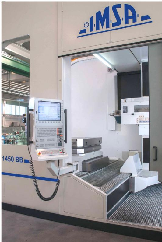
**La commande numérique Heidenhain TNC 640 a été dotée de fonctions spécifiques et de cycles d'usinage pour le forage profond et pour la transformation des coordonnées.**
