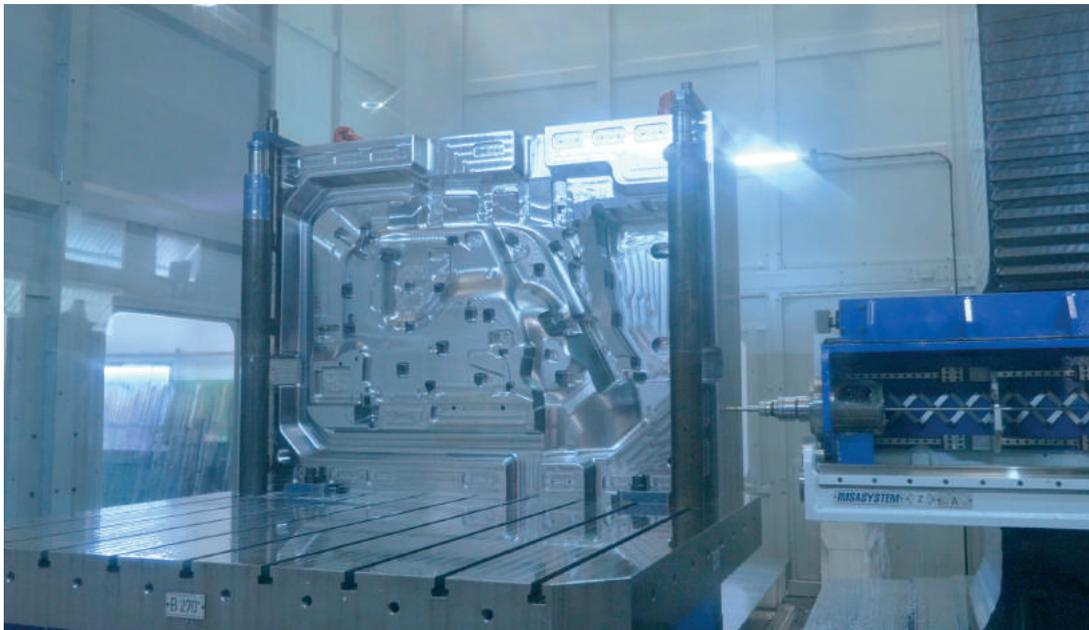
**Macchina di foratura profonda e fresatura con unità di lavorazione inclinabile MF1600S per la lavorazione di stampi fino a 20 t.**
