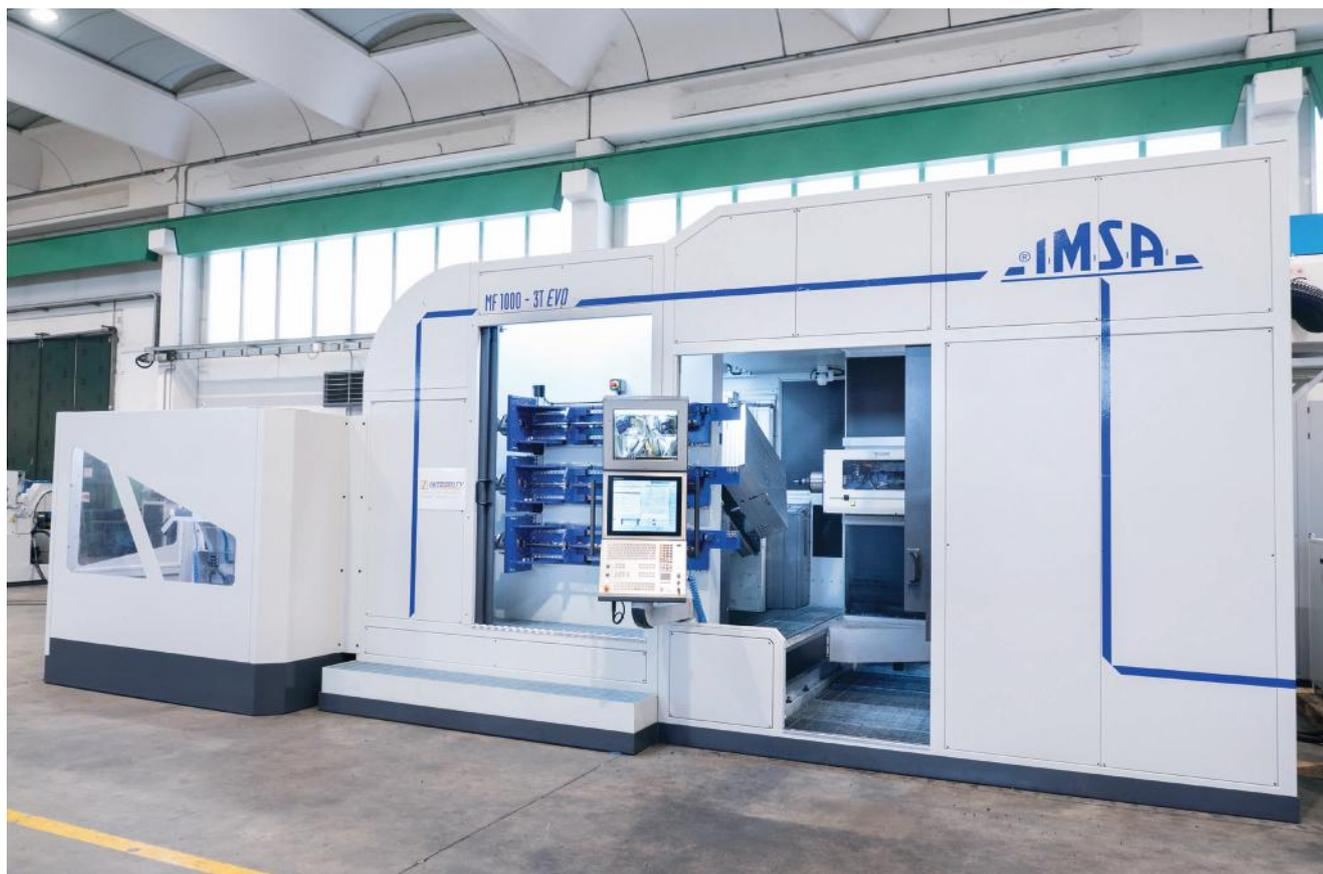
III Il montante gantry verticale su struttura macchina autoportante, e la tavola roto-basculante fino a 90°.
