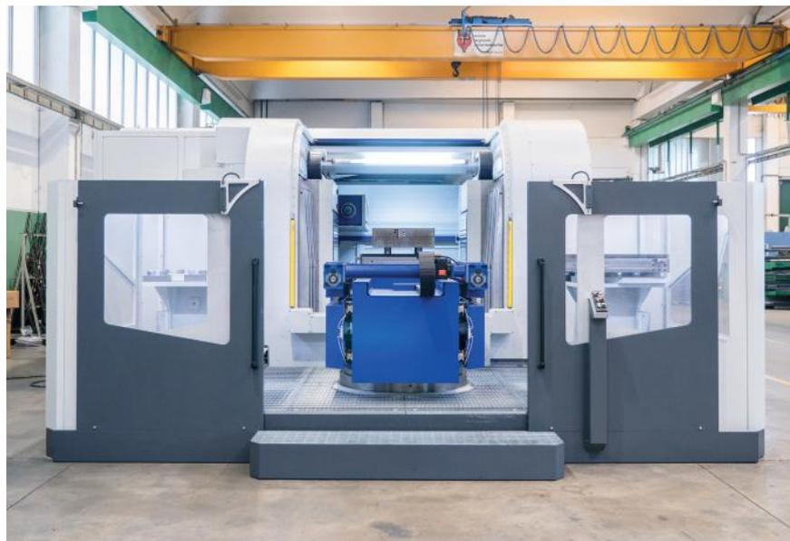
III Il cambio pallet a due posizioni è separato dall'area di lavorazione per permettere di predisporre lo stampo successivo in totale sicurezza.
