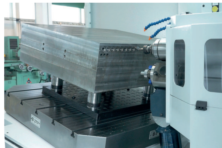
Il mandrino di fresatura è separato da quello di foratura, garantendo il passaggio fra operazioni in automatico.
