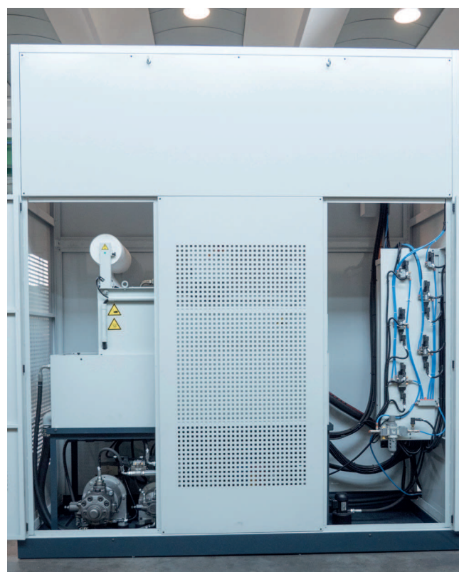
Unità di filtraggio e pompe sono integrate nella parte posteriore della macchina.
