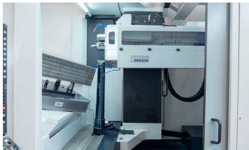
La nuova foratrice I.M.S.A. presenta il montante a portale verticale, garanzia di una rigidità 16 volte superiore a una equivalente struttura a montante mobile.
