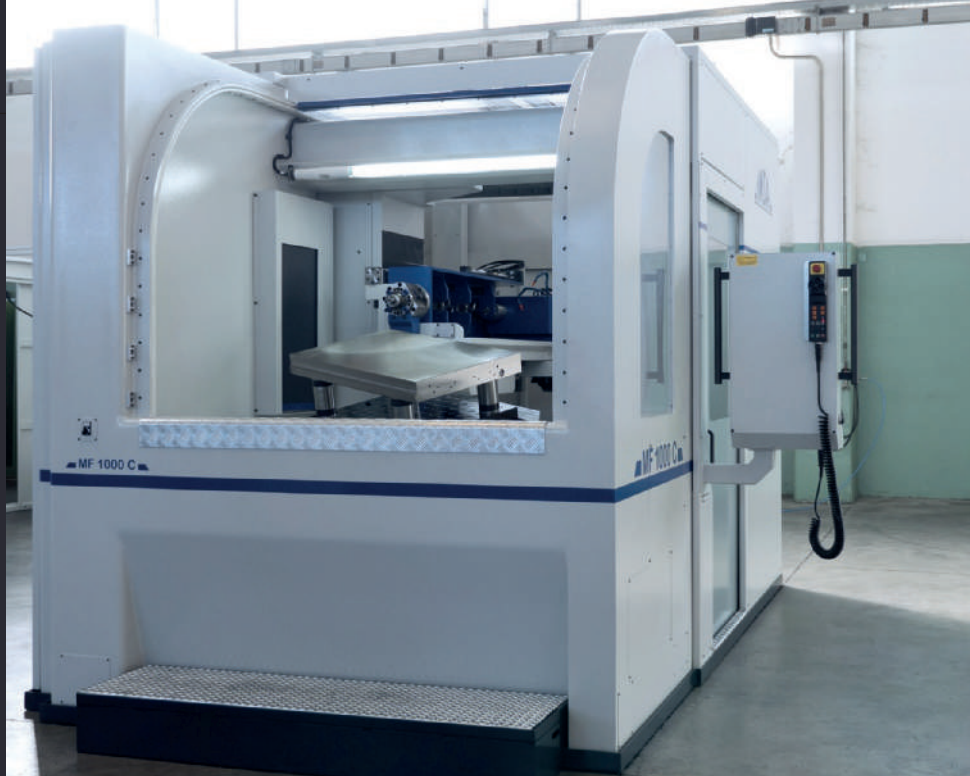
Foratrice/fresatrice per tasselli e piccoli stampi, e per particolari meccanici, la MF1000C è una macchina compatta, adatta anche alla foratura disassata (fuori asse) di pezzi cilindrici.
