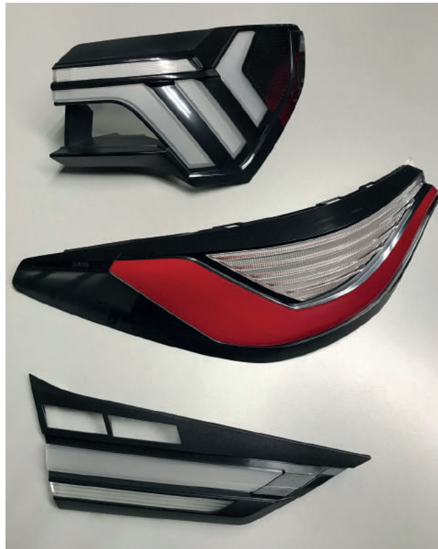
III Lenti interne posteriori stampate in tri-materiale per il settore automotive.
