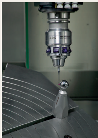
La funzione TNC KinematicsOpt contribuisce a realizzare una lavorazione estremamente accurata.
