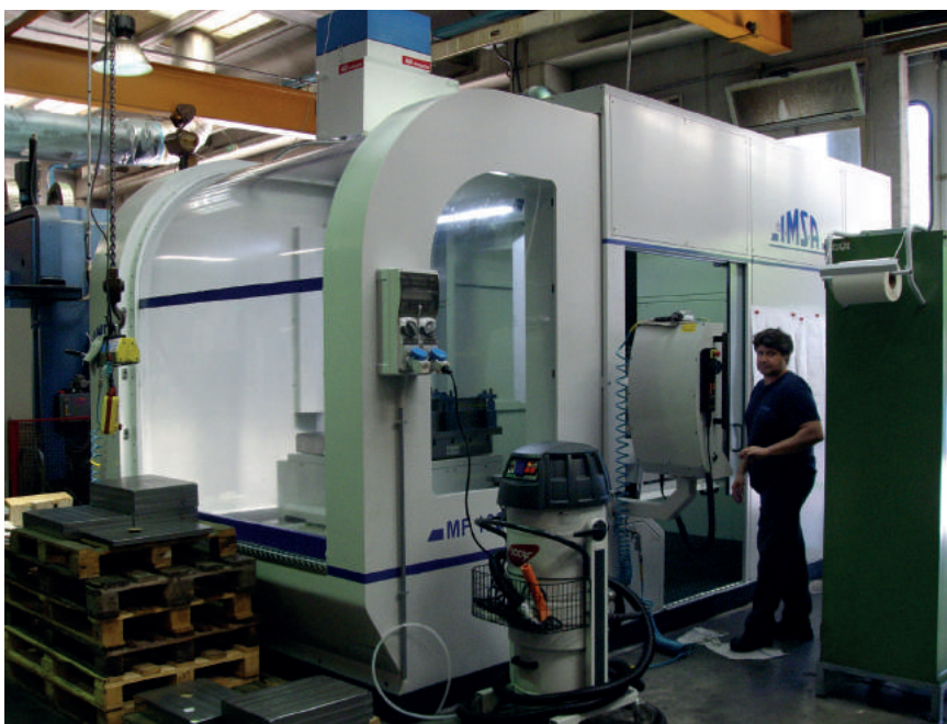
La nuova foratrice per fori profondi MF1250/2FL di I.M.S.A. installata in attrezzeria.
