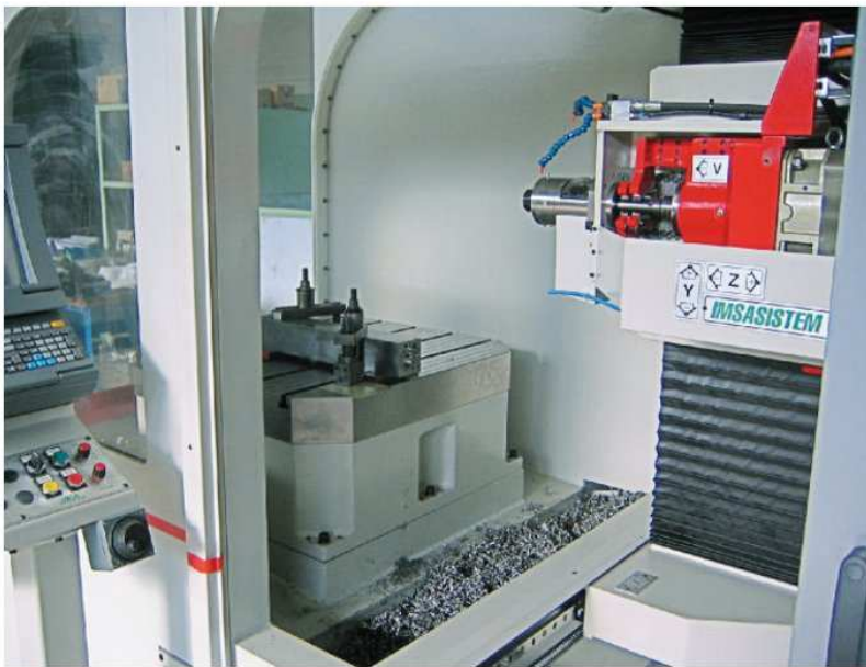
MF800C con tavola fissa 800 x 800 mm e con l'opzionale "kit" di fresatura, montato sull'unità per filettatura e piccola fresatura.
