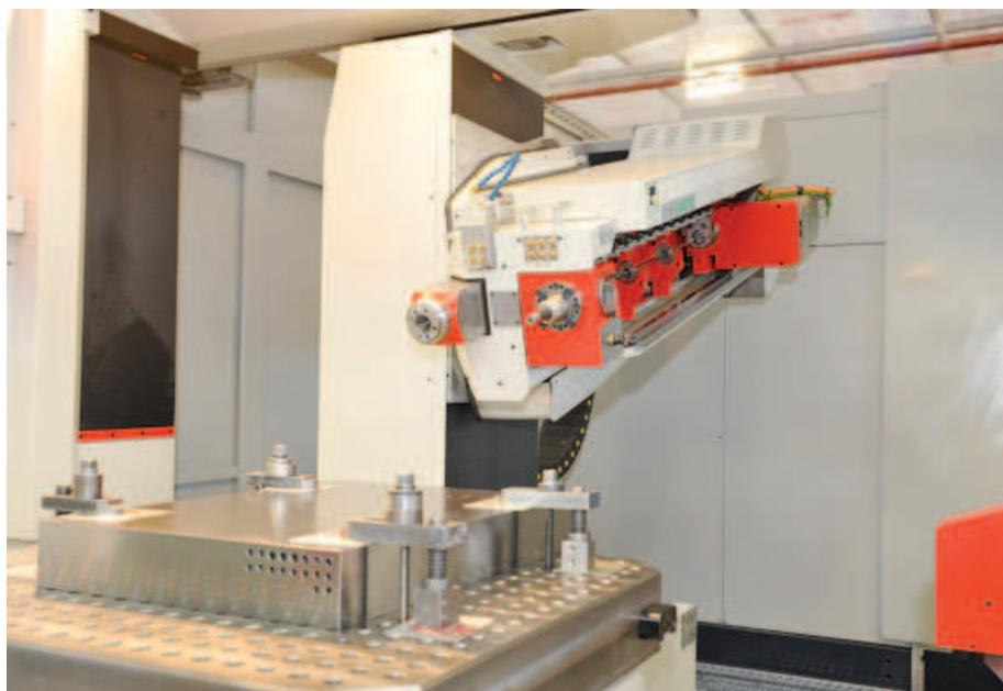
**Il mandrino di fresatura sulla stessa unità ma su asse separato da quello di foratura è tipico della serie BB di I.M.S.A. e permette di effettuare le lavorazioni di contorno senza intervento dell'operatore.**
