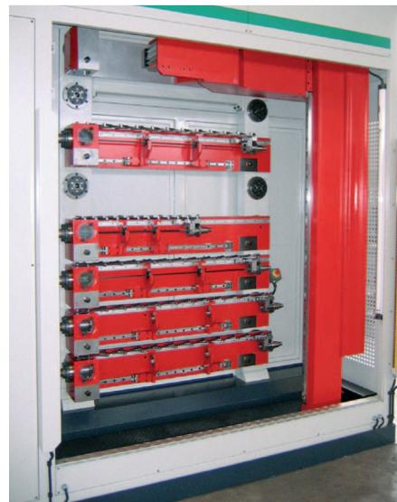
I gruppi di foratura profonda nel magazzino della MF100BLL/6P sono automaticamente sostituibili in modo da permettere il cambio di diametro di foratura senza intervento dell'operatore.
