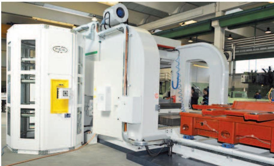
Il centro MF100BLL/6P è equipaggiato con due soluzioni FCS System per la sostituzione dell'intera tavola di staffaggio e dell'utensile di fresatura.
