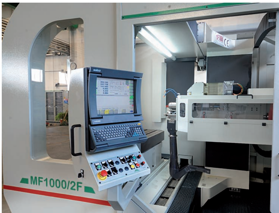
Fig 1 - La MF1000/2F esegue forature fino a 1000mm in ciclo unico, per diametri da 4 a 25 dal pieno e fino a 32 mm in allargatura
