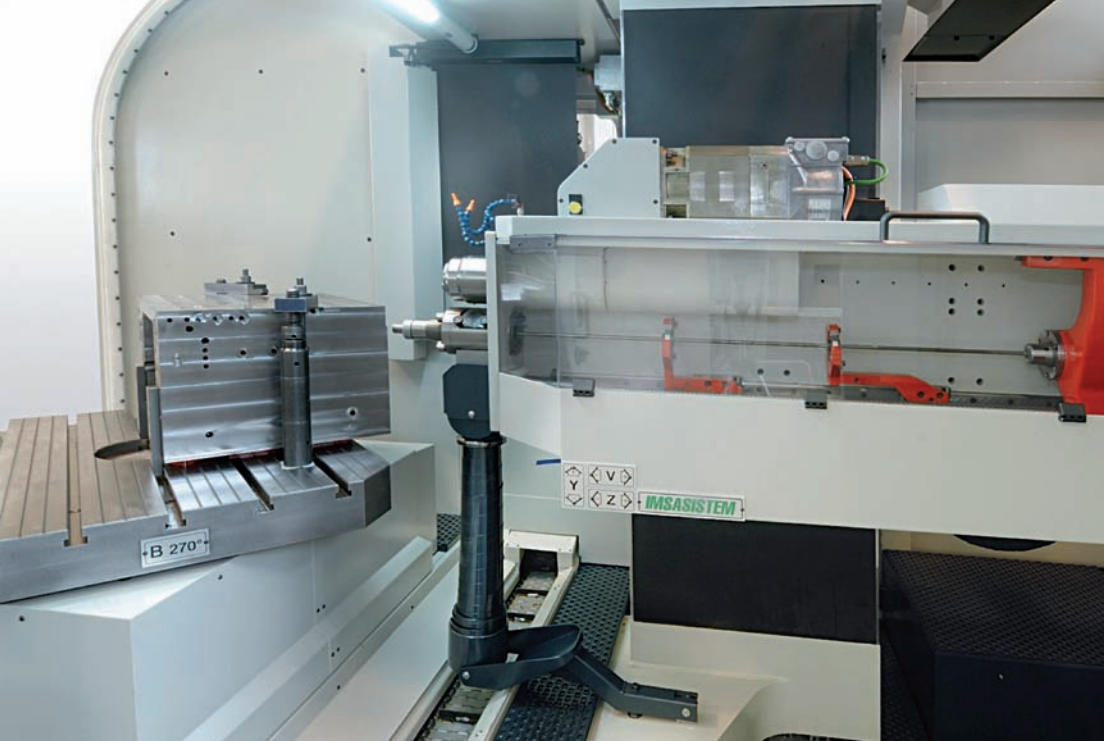
Fig 4 - Grazie ai due distinti mandrini per foratura e fresatura, il passaggio fra le lavorazioni non richiede l'intervento dell'operatore
