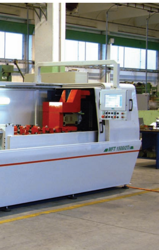
Fig. 1 - Foratrice profonda I.M.S.A. MFT 1500 2Ti / 25CR.
