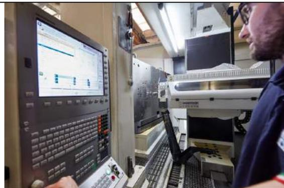
Caractéristiques communes aux deux centres Imsa choisis par Claren Tools, la colonne à portique vertical assure une rigidité maximale, et le système de broches indépendantes pour le forage profond et le fraisage permet de longues opérations d'usinage sans supervision.
