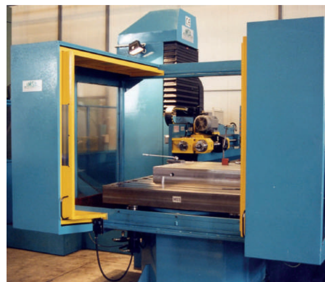
La prima foratrice IMSA nata del 1992 (macchina verde) e una foratrice del 1996 che già presenta due mandrini separati per la foratura profonda e le lavorazioni complementari.
