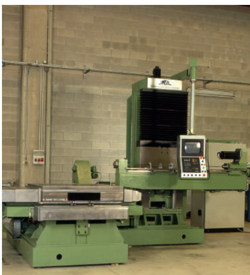
La prima foratrice IMSA nata del 1992 (macchina verde) e una foratrice del 1996 che già presenta due mandrini separati per la foratura profonda e le lavorazioni complementari.
