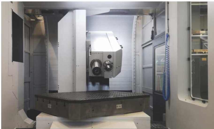
Il centro di foratura profonda e fresatura MF1350EVO per stampi e portastampi fino a 12 t.
