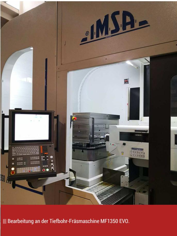
III Bearbeitung an der Tiefbohr-Fräsmaschine MF1350 EVO.
