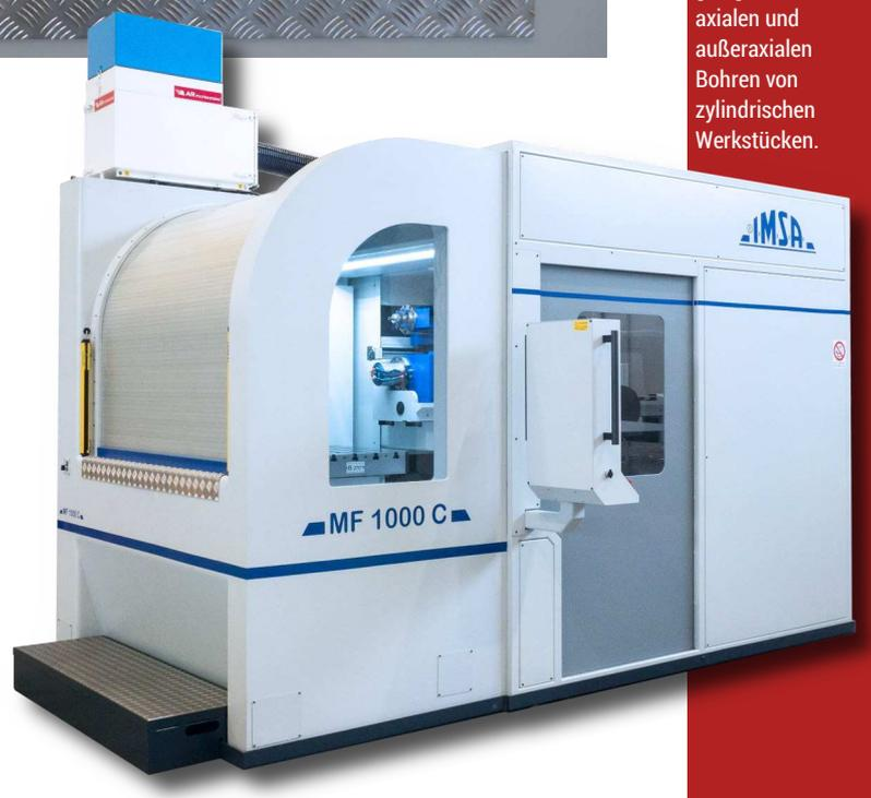
Parameter ausgestattet, mit selbstregulierenden Hochdruckpumpen, automatischen 16-µm-Filtereinheiten und Kühleinheiten, um die Temperatur unter 32 °C zu halten.
