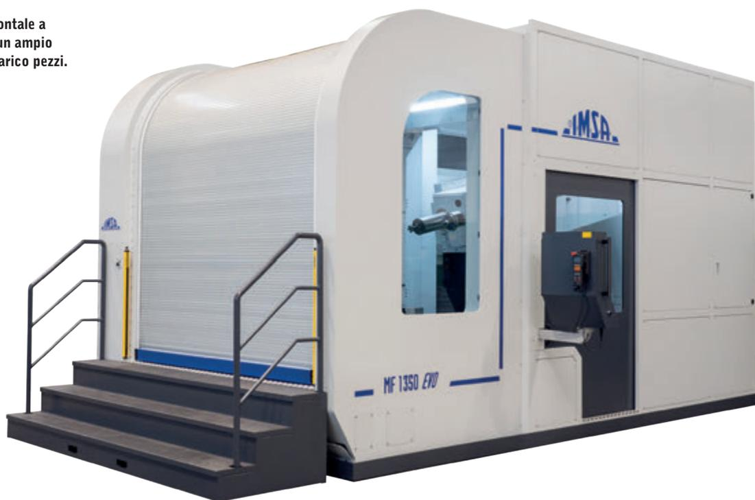
III L'unità di lavorazione alloggia le due unità, di foratura profonda e fresatura, dotate di nuovi mandrini raffreddati a liquido.
