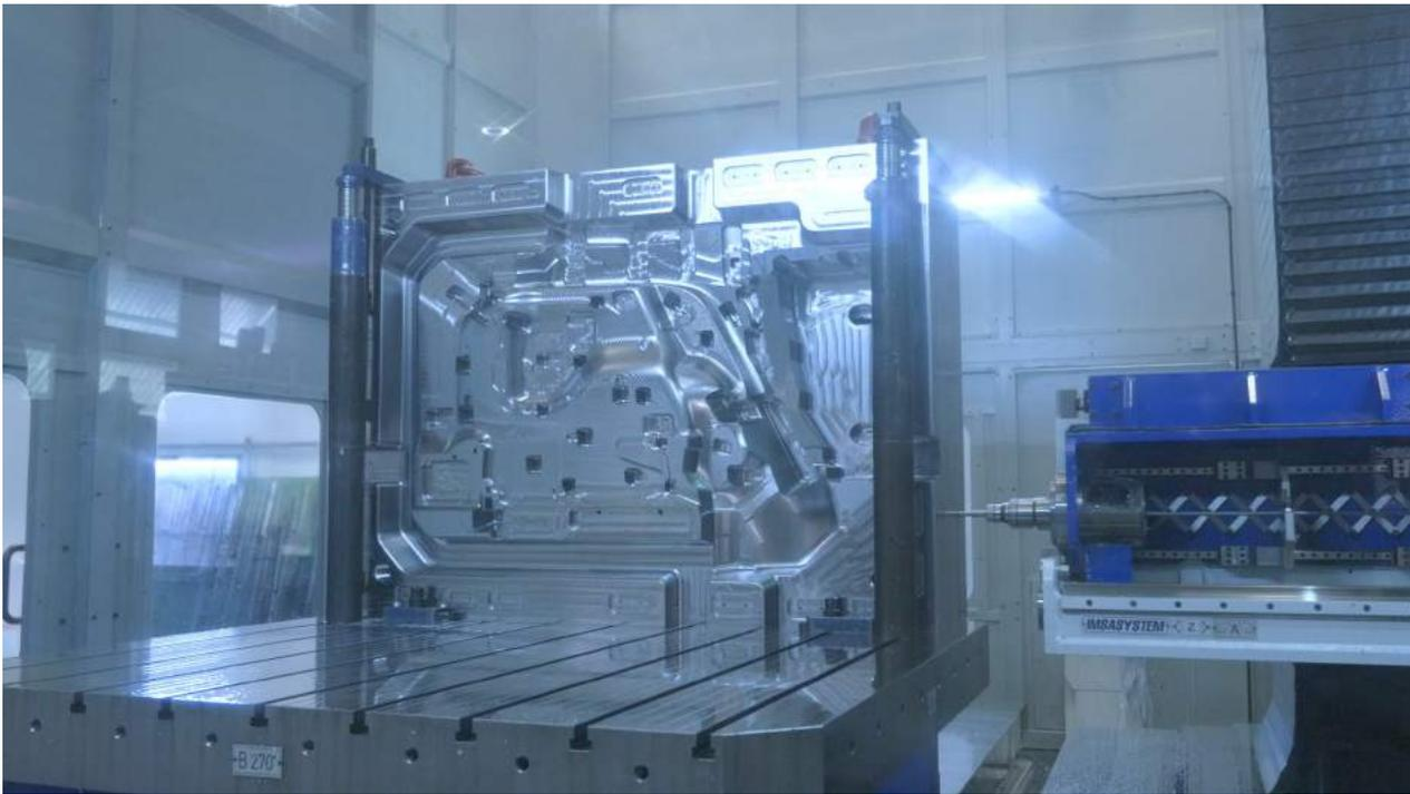
**Machine de forage profond et de fraisage MF1600S, avec unité inclinable, pour l'usinage de moules jusqu'à 20 t.**
