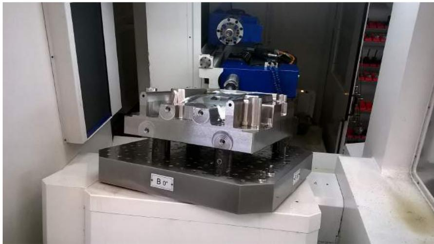
Moule usiné avec une foreuse/fraiseuse IMSA MF1000C
