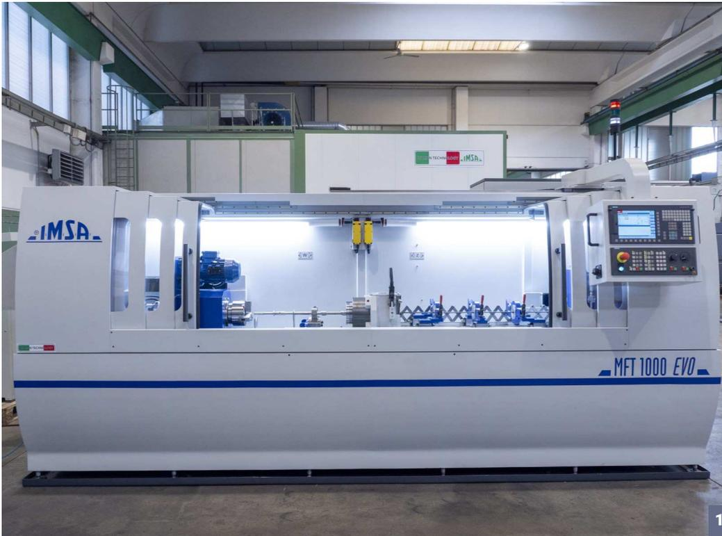
Zwei Tiefbohrmaschinen von I.M.S.A. MFT, die zwischen Juni und Juli dieses Jahres an Kundenunternehmen ausgeliefert wurden, weisen einige Verbesserungen auf, die der Hersteller durch Hinzufügen des Kürzels EVO zum Namen der Maschine hervorheben wollte. Ein Modell wurde für einen französischen Werkzeughersteller gefertigt, das andere wurde für ein italienisches Unternehmen aus dem Bereich der Luftfahrt entwickelt.
