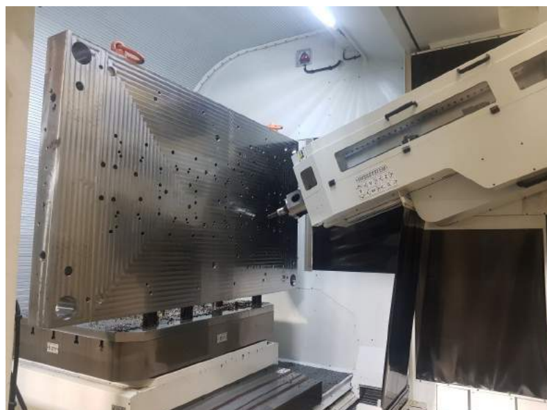
L'atelier est équipé de la machine de forage profond MF 1450BB d'I.M.S.A.
