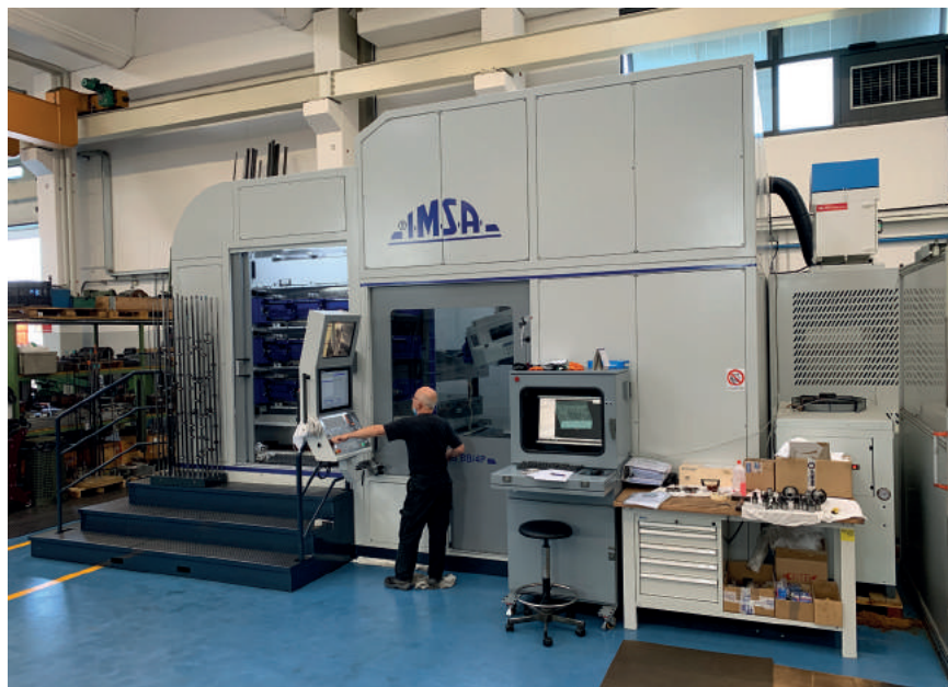
Il centro di foratura profonda IMSA MF1300/4P EVO presente nell'attrezzeria di R.S. Meccanica.
