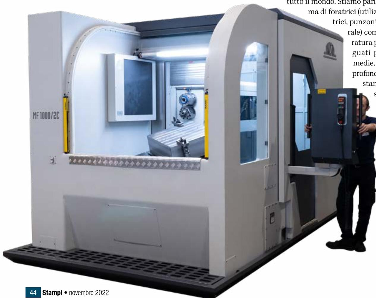
**Progettata per lavorare stampi e blocchi fino a 2 o 4 ton, la nuova foratrice MF1000/2C può realizzare forature dritte, inclinate o a doppia inclinazione, a seconda della tavola prescelta**
