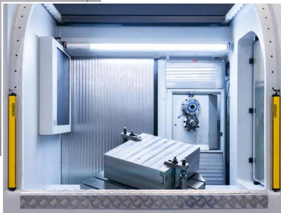
Le protezioni scorrevoli a lato del montante, sopra e sotto la testa, mantengono meglio i trucioli entro l'area di lavorazione
