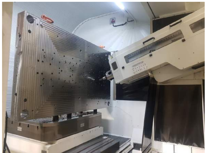
Werkzeugbau mit Tiefbohrmaschine MF 1450BB bei I.M.S.A.
