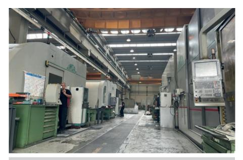
Innerhalb der Tiefbohrinsel sind die Maschinen so angeordnet, dass der Zugang immer zum Inneren der Zelle hin erfolgt, um den Arbeitsablauf zu erleichtern
