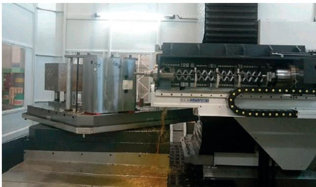
**Con una corsa sopra tavola di 500 mm, il centro di foratura profonda MF1600S è in grado di gestire sia uno stampo da 3.000x2.000 mm, sia un blocco di posizioni relativamente piccole in singolo piazzamento a centro tavola.**
