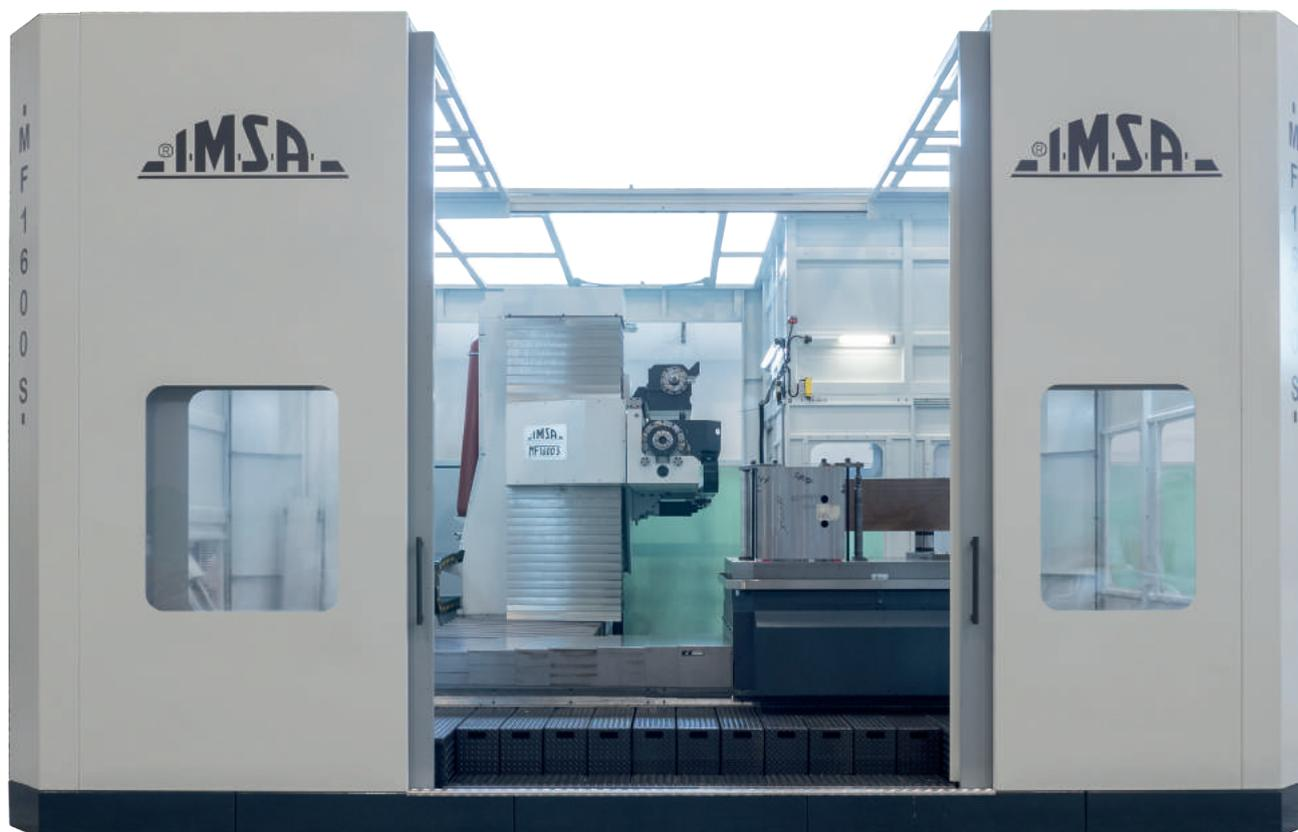
**Il centro di foratura profonda e fresatura MF1600S di I.M.S.A. è dedicato alla lavorazione di stampi fino a 20 t. La solidità della macchina è evidente dalla struttura elettrosaldata da 38 t di peso, interamente realizzata in Italia.**
